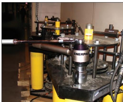
◀ Braço de Reação Enerpac para o Multiplicador de Torque E393 usado para multiplicar manualmente o torque nos parafusos até 4300 Nm.
