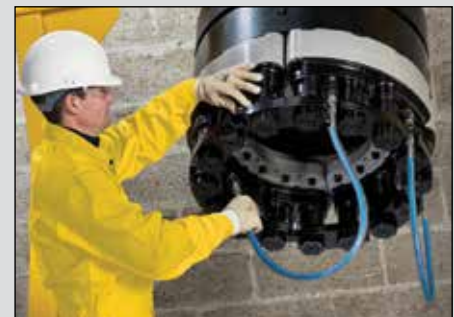
▲ Aplicación del tensado de múltiples tornillos.
