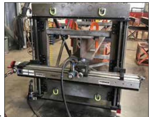
Fresado de la cara final de una viga en I con una GMRF1000. ▶
