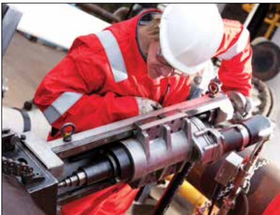
▼ Máquina portátil para taladrado HT40.
