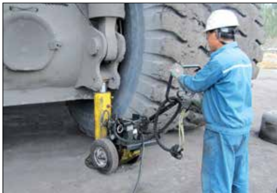
◀ POW'R-RISERS® Enerpac usados en operaciones mineras para levantar equipos pesados.
