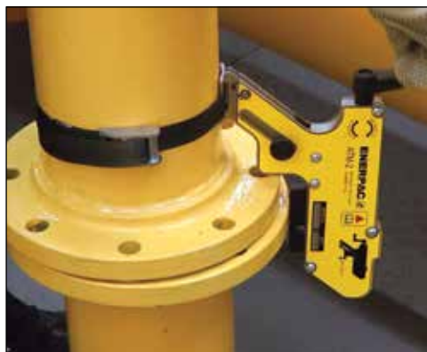
◀ La herramienta compacta ATM2 se acciona de manera simple, girando la manija.
