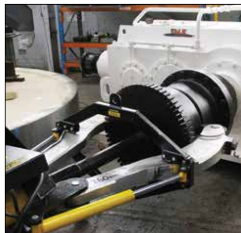
▲ El EPH1002 extrae rápida y fácilmente este acoplamiento motriz de su eje.
