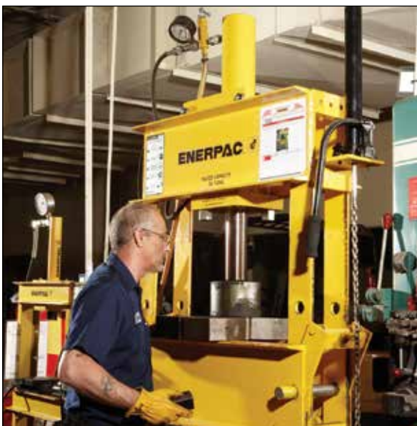
◀ La prensa Enerpac con bastidor en H facilita la remoción del eje de este montaje.
